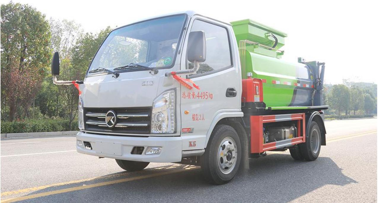
餐厨（泔水）垃圾车：又称厨余垃圾车余厨垃圾车或者泔水车，是垃圾车的一种，主要用于收集和运输生活垃圾，食品垃圾（泔水）及城市淤泥的专用车辆。可配装载不同规格的标准垃圾桶，广泛应用在宾馆、饭店、食堂、学校等单位的餐厨泔水处理。具有装、卸垃圾自动化程度高、工作可靠、密封性好、装载容积大、操作简便、作业过程密闭，无污水泄露和异味的散发，环保性好等特点。
